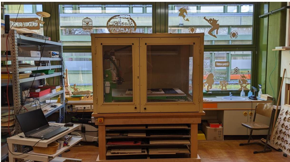
Seit dem Jahr 2023 ist ein Lasercutter (auch der Firma EAS) im Einsatz. Das Gerät ist mit einer bearbeitbaren Fläche von 600 mal 400 mm bestens für filigrane Feinarbeiten geeignet:
